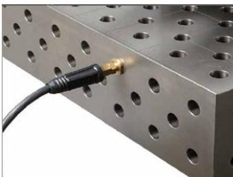
7.3 接地器：接地器能保证焊机可靠接地，提高焊接质量，更好地保护工作面不受损害
